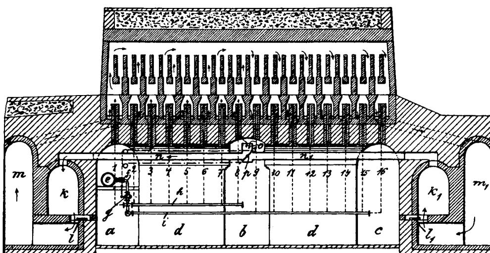
**Louis Röder, Wolfenbüttel, und Albert Peust, Senftenberg, N.-L. Verf. zur Brikettierung der Braunkohlenschlämme, gekennzeichnet durch den Zusatz unverkohlten Holzes der Kohlenflöze (oder anderen Holzes) und hygroskopischer Salze, insbesondere des Chlormagnesiums, zu den feuchten Kohlenschlämmen vor der Trocknung. —**
