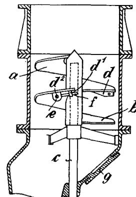
**ünierlichen Herstellung von Leuchtgas**, dadurch gekennzeichnet, daß die Kohle in einer verhältnismäßig dünnen Schicht destilliert wird, welche in horizontaler Richtung länger ist als in vertikaler Höhe und mit einer über den ganzen oder größeren Teil der Oberfläche sich hinziehenden Gasableitung versehen ist.
